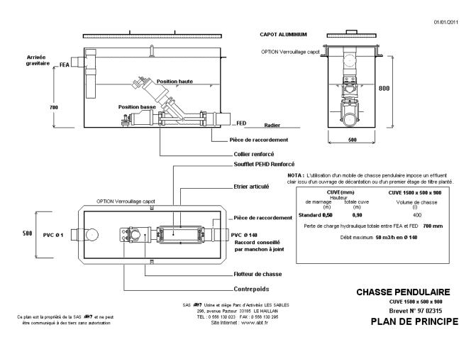
L'ouvrage doit être placé sur une surface plane, horizontale, obtenue par terrassement en pleine fouille, et reposé sur un radier béton de 10 cm d'épaisseur.
