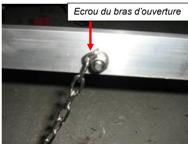
Photo n°2 : Ecrou du bras d'ouverture. Le maillon doit se trouver vers le clapet
