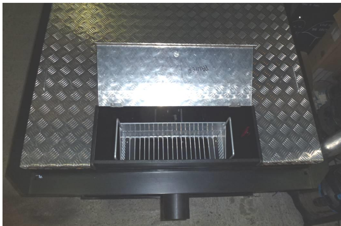
Trappe d'accès au panier dégrilleur pour une chasse de 1500 x 1130, Volume maximum 600 litres.
