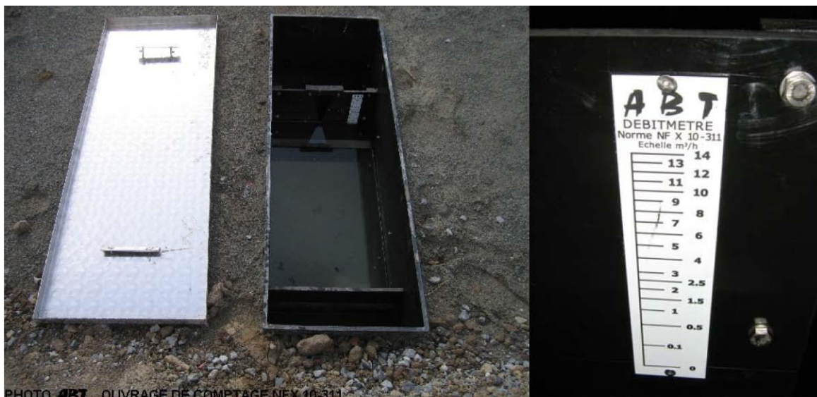
PHOTO ABT OUVRAGE DE COMPTAGE NFX 10-311
